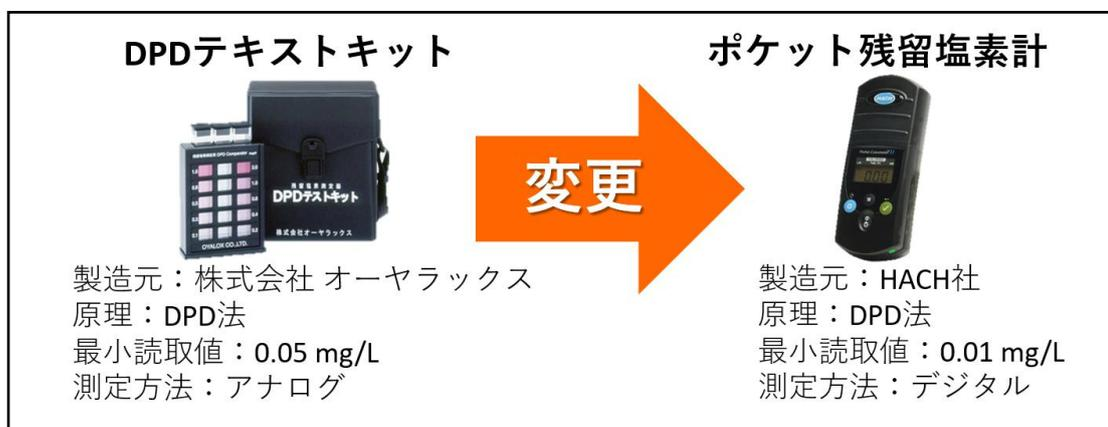
図 2 残留塩素測定機器の変更
