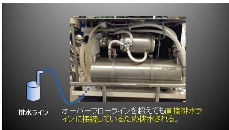
図4 排水ラインへの接続
